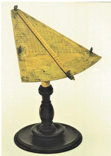
Fig. 14, Strumenti del XV - XVI sec. per verificare distanze, altezze, angolature in agrimensura. a) - Archipenzolo, di semplice fattura e precisione, serviva a rilevare l'orientamento su un piano b) - Quadrato geometrico, di antichissima origine, fu poi perfezionato da Nicolò Tartaglia nel 1525 c) - Ottante, permetteva operazioni di rilevamento usando misure angolari
