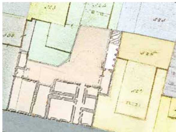
Fig. 18 La sovrapposizione della pianta attuale del piano terra di palazzo Cimaschi (color ocra chiaro) su quella Bonicelli del catasto napoleonico. Di colore più chiaro le stanze con le architetture del XV secolo.
